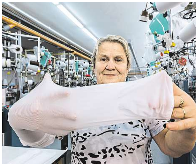
Zásah lidské ruky. Pletací stroje umí vyrobit jen jakousi trubici. Špičky ponožek, podkolenek a punčoch se musí přišít ručně.
